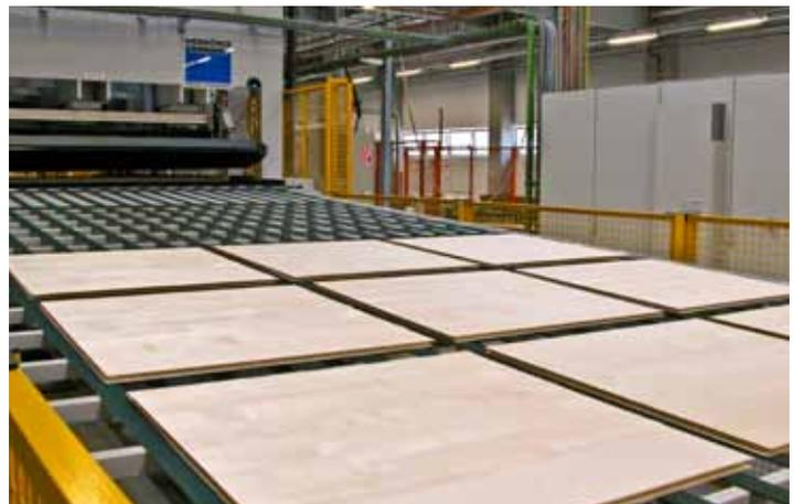
Проходные прессовые линии Wemhöner в одноэтажном исполнении идеально подходят для процесса облицовки древесных плит шпоном, повышающего ценность продукции. В основном они используются для производства материалов для изготовления дверей, панелей и напольных покрытий. Как модели начального уровня, так и полностью автоматизированные системы могут быть оснащены оборудованием, обеспечивающим максимальную гибкость при мелкосерийном и крупносерийном производстве.
